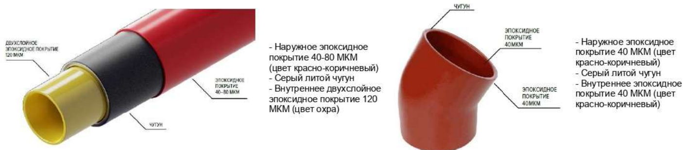
Рис. 1 Материал и покрытие труб и фитингов SML
