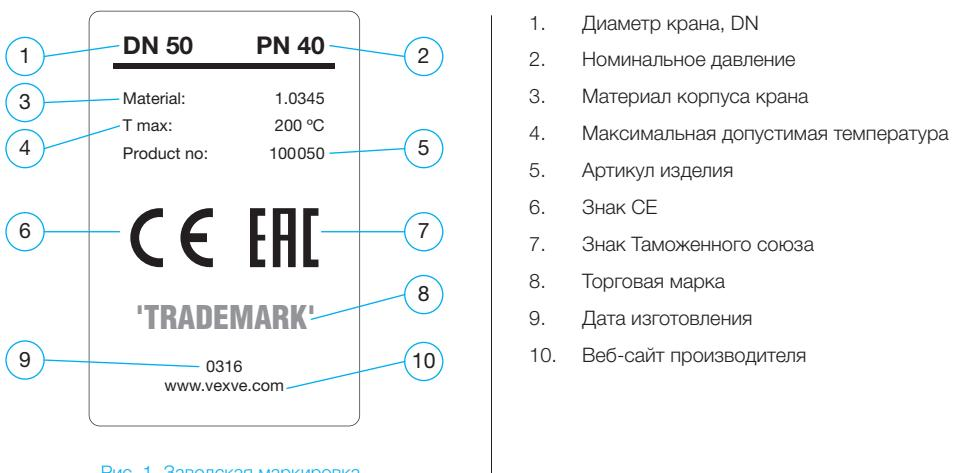
Рис. 1. Заводская маркировка
