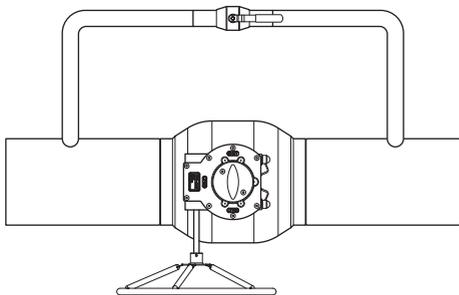
Во избежание гидравлических ударов и для снижения сил, создаваемых при открытии крана под давлением, для шаровых кранов  $\geq DN 150$  рекомендуется использовать перепускной кран (см. рис. 11).
