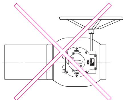
Рис. 9. Не используйте кран на конце трубопровода
