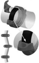
Используют для трубного соединения на неровных участках, а также в системах, подвергающихся воздействию повышенной вибрации или внешних сил, таких как сейсмические явления. При проектировании системы с использованием гибких муфт необходимо предусмотреть дополнительные опоры для системы, чтобы исключить нежелательные нагрузки.
