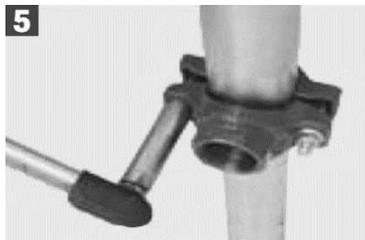
Равномерно затяните гайки, пока детали корпуса отвода плотно не соприкоснутся с трубой.
