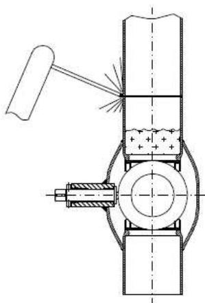
Сварка верхнего шва при закрытом кране должна происходить при наличии воды в кране.
