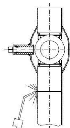
При сварке нижнего шва газом, кран должен быть закрытым.
