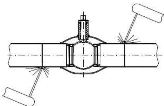
При приварке крана к горизонтальному трубопроводу кран должен быть полностью открытым.
