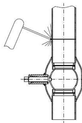
При приварке крана к вертикальному трубопроводу при сварке верхнего шва кран должен быть открытым.
